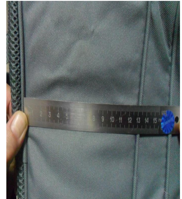
нарушение требований приложения 14 табл. 2 п. 6 ст. 6 ТР ТС 007/2011 - увеличение размеров допускается не более чем на 30 мм
